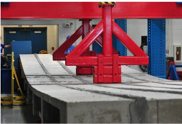
桁に荷重がかかり、桁のたわみが生じている
