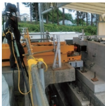
プレキャスト壁高欄衝突試験
